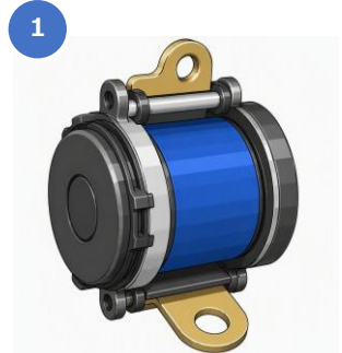
1 リトラクター シートベルトを巻き取り、衝突時にロックして乗員を拘束
