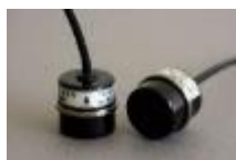
震度測定に不可欠な 地震加速度計
