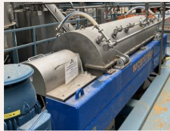
Ingomar遠心分離機・・・遠心分離で繊維量の調整が可能となり、KIUS（二次加工）の歩留まり改善に貢献
