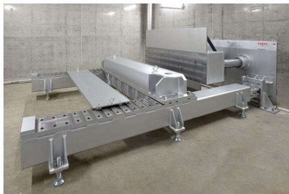
圧壊試験機(第1安全試験室)
