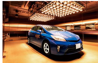
自動車が一台入る 実車試験装置
